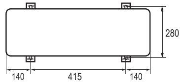
Outdoor unit floor fixing dimensions. Units in mm Algunos sistemas de 9 000 BTU/h, y algunos 12 000 BTU/h de capacidad
